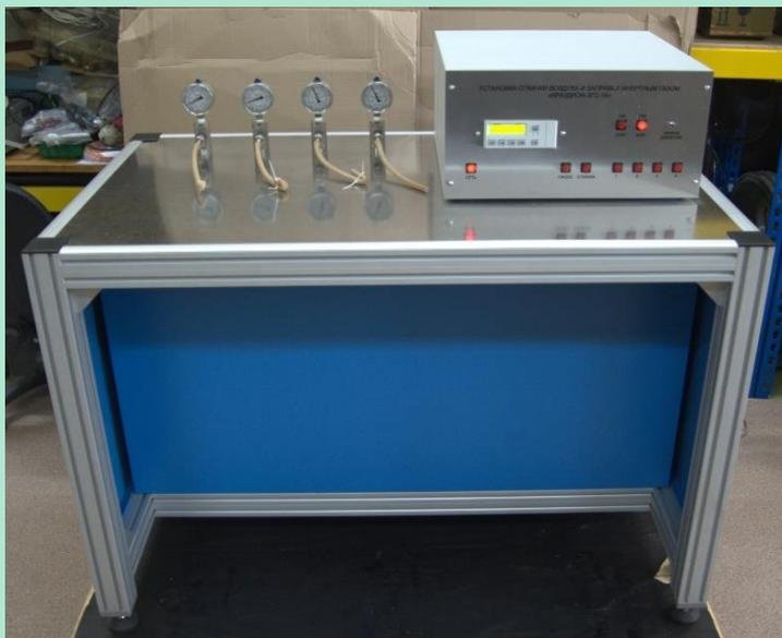
Установка откачки воздуха и наполнения инертным газом «КРАУДИОН-ЗГС-16» предназначена для откачки воздуха из изделий и заполнения их внутреннего объема азотом, аргоном, гелием, аргон-гелиевой смесью или другими невзрывоопасными, неагрессивными и нетоксичными газами и смесями газов до заданного давления.
