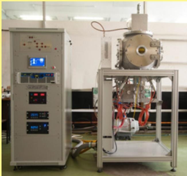
Установка «Батискаф-1» предназначена для нанесения:
