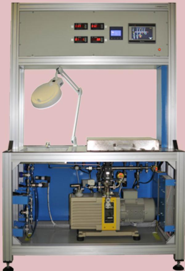
Установка предназначена для контроля герметичности, термовакuumной сушки и наполнения инертными газами и от одного до четырех изделий размерами до 250×150×40 мм.
