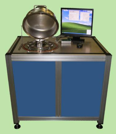
Установка «КРАУДИОН-РПЧ1-09» предназначена для подстройки частоты кварцевых резонаторов/пьезоэлементов термическим напылением. На установке «КРАУДИОН-РПЧ1-09» выполняется процесс термического напыления пленки серебра на электрод резонатора для настройки его частоты в сторону уменьшения значения данного параметра.
