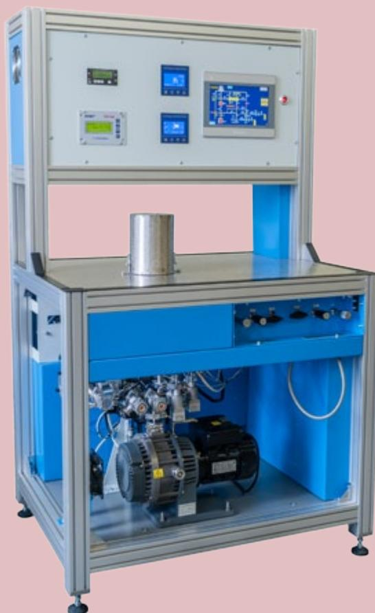
Установка предназначена для контроля сорбционных свойств (емкости и скорости поглощения водорода) нераспыляемых газопоглотителей (геттеров) различной формы и размеров. Количество поглощаемого газопоглотителем газа определяется по уменьшению давления в измерительном объеме, состоящем из калиброванной емкости и измерительной колбы. Установка обеспечивает проведение следующей последовательности технологических операций:
