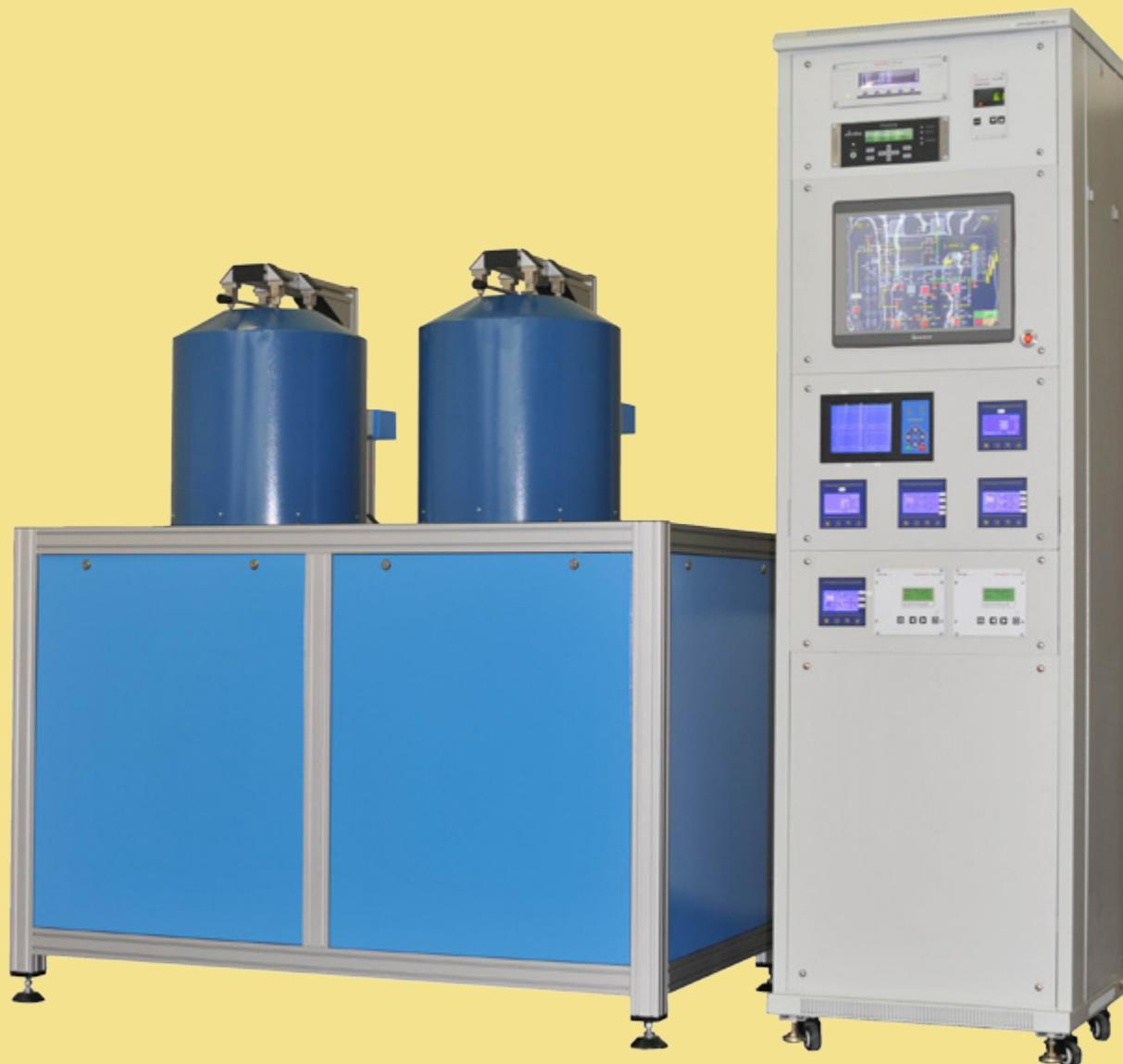
Вакуумная установка «КРАУДИОН-ЭВО-13/2-350» предназначена для финишной электровакуумной обработки 2-х изделий (ЭВП).
