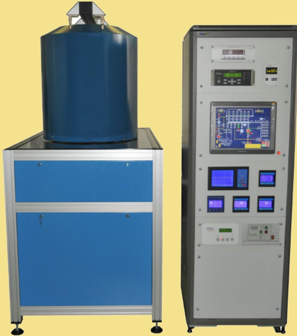
Вакуумная установка «КРАУДИОН-ЭВО-12/6-300» предназначена для окисления катодов, применяемых в производстве ЭВП. Установка обеспечивает проведение следующих технологических операций:
